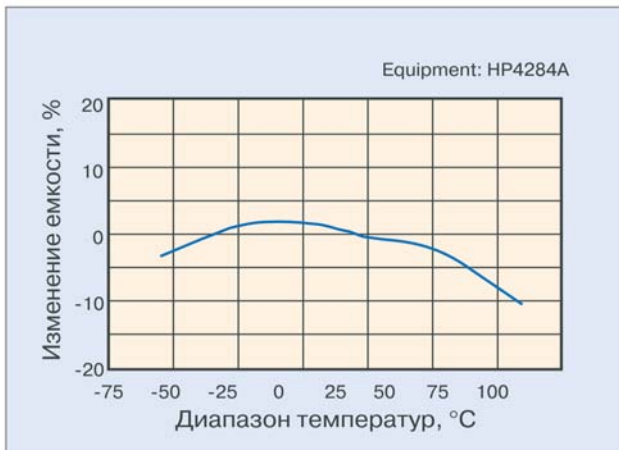
Рис. 3. Температурная характеристика чип-конденсатора типоразмера 0603
